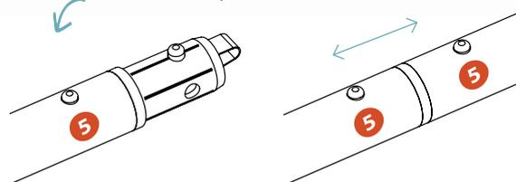
Assemblage des sections 50 mm
