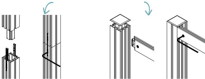
Les profils Linear se manchonnent grâce à un système de connecteurs déjà intégré au profilé.
