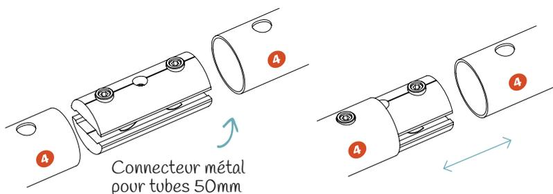
Verrouillage des sections par clé Allen
